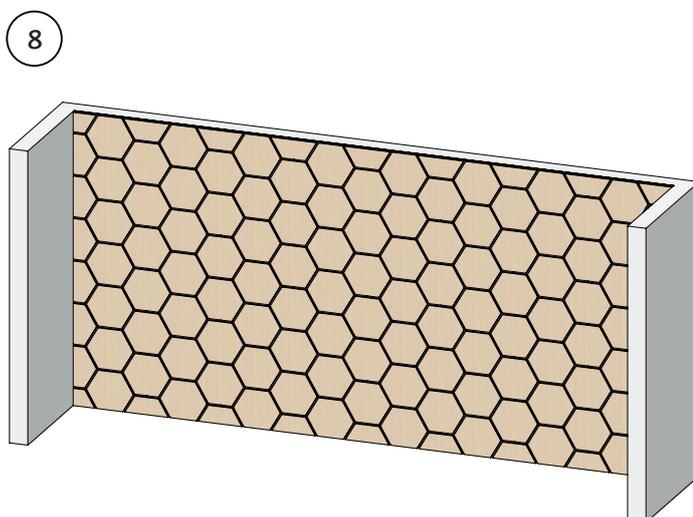
8. Quando tutti i pannelli Nastro-Esagono sono montati sulla parete. Controllare i giunti esagonali: se un esagono fuoriesce dal feltro, utilizzare il nostro adesivo per incollarlo al feltro, se necessario. Se durante l'installazione uno dei bordi degli esagoni ha subito un colpo, utilizzare della carta vetrata per smussarlo.
